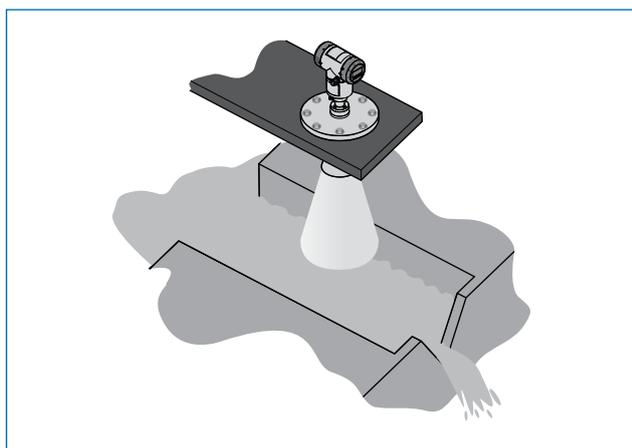
Полевые устройства могут измерять расход, если они настроены с помощью программного обеспечения PACTware™. Функция преобразования уровня в расход поддерживается драйвером DTM, поставляемым вместе с прибором. В меню доступны для выбора 6 открытых профилированных лотков Parshall (ISO 9826), Venturi Rectangular (ISO 4359), Venturi Trapezoidal (ISO 4359), Venturi U (ISO 4359), V-Notch (ISO 1438) или Rectangular Notch (ISO 1438).
