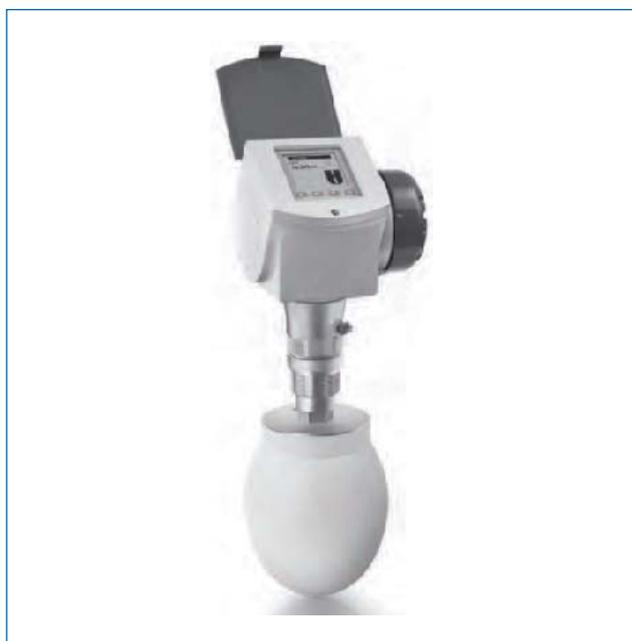
Радарные уровнемеры OPTIWAVE 6300 имеют новый, уникальный тип антенны для измерения уровня сыпучих продуктов, гранул и порошков в условиях сильной запыленности. Эллипсоидальная форма антенны предотвращает налипания продукта на ее поверхность. Кроме того, она позволяет сгенерировать узконаправленный радиосигнал, с помощью которого достаточно легко произвести точные измерения сыпучих продуктов.
