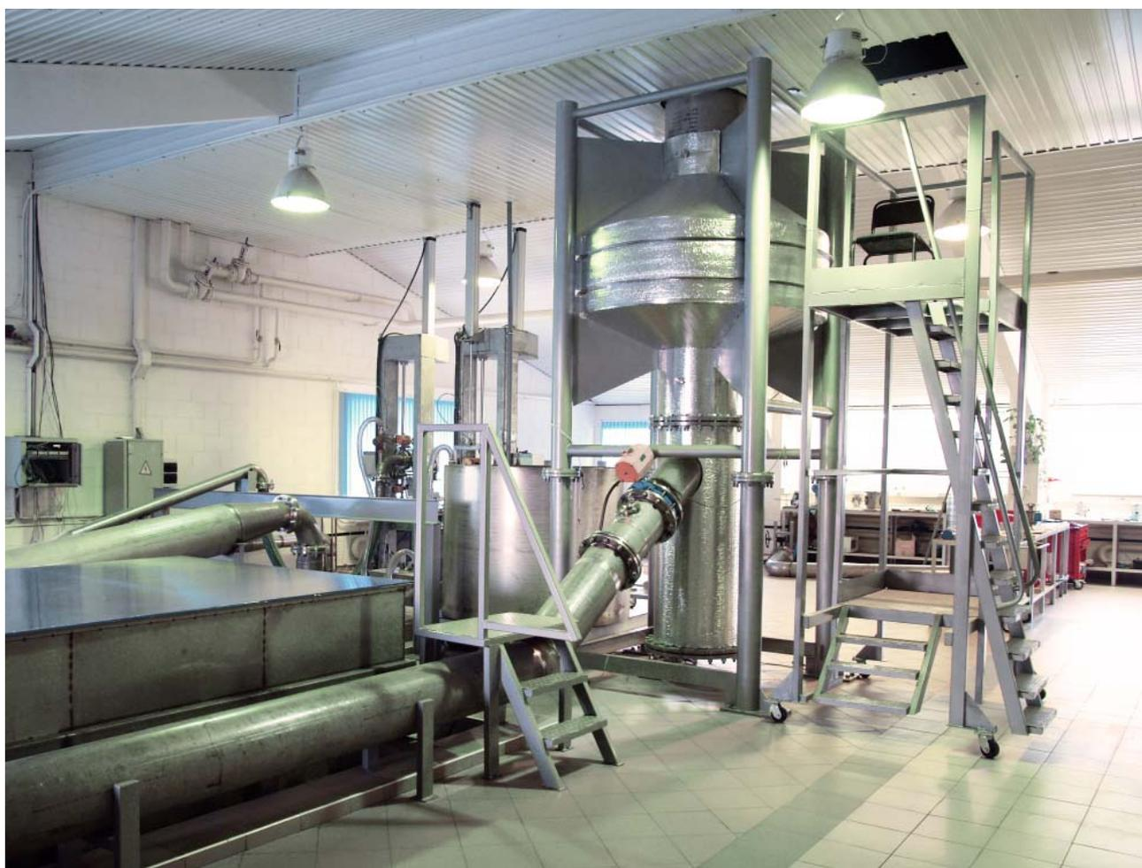
Установка поверочная расходомерная предназначена для поверки, регулировки, градуировки расходомеров, счётчиков и преобразователей объёма/расхода жидкостей различных типов: турбинных, электромагнитных, ультразвуковых, вихревых и др., с диаметром условного прохода от 25 до 300 мм и диапазоном измеряемых расходов от 0,9 до 500 м<sup>3</sup>/ч.
