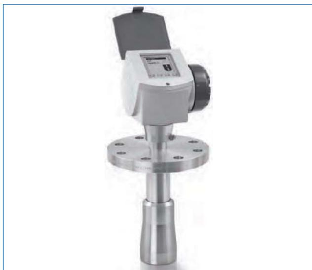
Рупорные антенны рекомендуется применять в тех случаях, когда измерения производятся в силосах, работающих под большим давлением или при высоких температурах, при измерении гранулированных продуктов. Это связано с тем, что они могут выдерживать сильные механические нагрузки.
