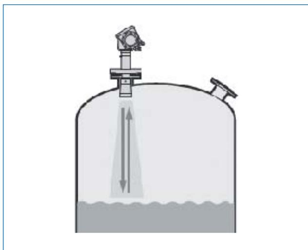
Радарные уровнемеры OPTIWAVE 7300 могут измерять уровень большинства известных жидких продуктов, включая сжиженный природный газ, с разнообразными вариантами монтажа. После установки прибора можно произвести быструю наладку прибора с помощью программы «Мастер настройки».
