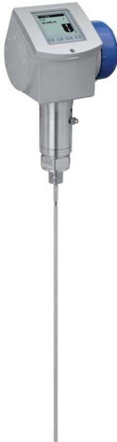
Рефлекс-радарный уровнемер OPTIFLEX 1300, основанный на принципе действия TDR ( Time Domain Reflection – измерение времени отражения сигнала), предназначен для измерения дистанции, уровня, дистанции и уровня границы раздела фаз, объема и массы жидких и сыпучих продуктов, паст, гранул и порошков. Пять различных типов сенсоров обеспечивают универсальность применений прибора.
