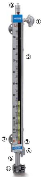
Приборы версии Basic идеально подходят для измерения жидкостей с диапазоном плотности от 0.75 до 1.19 г/см<sup>3</sup>, температурой до 150 °С или давлением до 1,6 МПа. Значение уровня может быть передано в систему контроля с помощью аналогового преобразователя ER/INOR.
