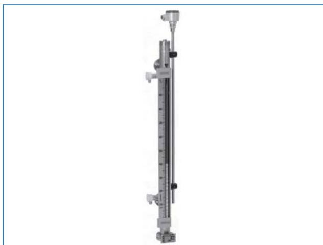
Для случаев, когда требуется установка в местах с небольшим пространством под нижним технологическим присоединением, мы рекомендуем использовать приборы BM 26 A. Также BM 26 A идеально подходят для измерения уровня сжиженного попутного (нефтяного) и природного газа. Они работают при плотности продукта в пределах 0,5...3 г/см<sup>3</sup>, интервале температур от -200 до +300 °С и давлении до 12 МПа.
