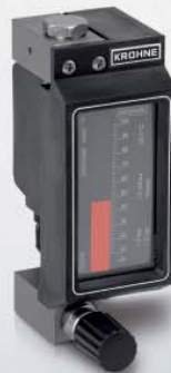
DK37 M8E Для малых расходов, с токовым выходным сигналом
