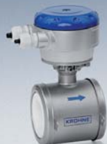
OPTIFLUX 5000 «сэндвич» Высокая степень устойчивости к агрессивным и абразивным средам, высокая точность благодаря керамической футеровке
